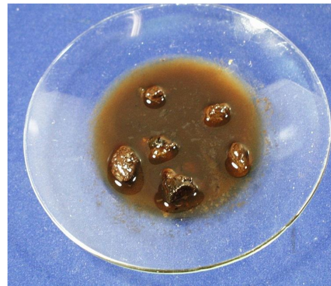
Mocno zniszczona ciecz solarna
