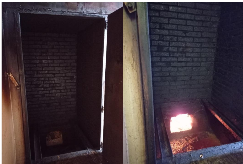
Rysunek 4.51 Widok pustej komory wędzarniczej przygotowanej do odpalania paleniska oraz komory po rozpaleniu płomienia w palenisku. Źródło: opracowanie własne
