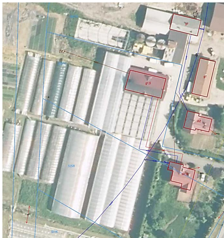
Rysunek 7.2 Połączenie sieci wodnej oraz CO pomiędzy bud. gospodarczym a domem właścicieli. Źródło: www.geoportal.gov.pl
