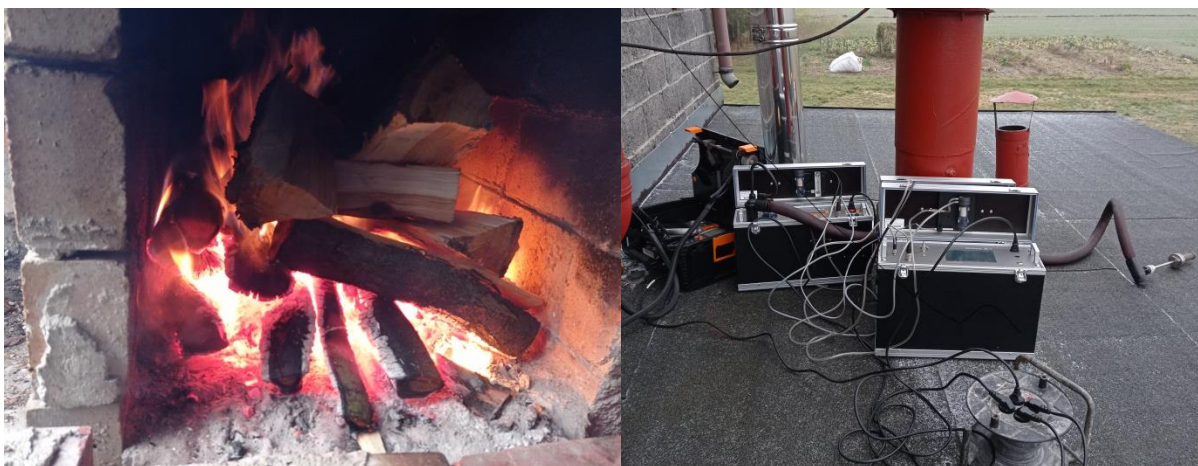
Rysunek 4.70 Widok komory paleniskowej w trakcie wędzenia. Widok na dach oraz urządzenia pomiarowe w trakcie przygotowań do badań. Z uwagi na trudne warunki pogodowe oraz silny wiatr zastosowano ochronę przeciw wietrzną, aby dym nie cofał się do wędzarni. Źródło: opracowanie własne
