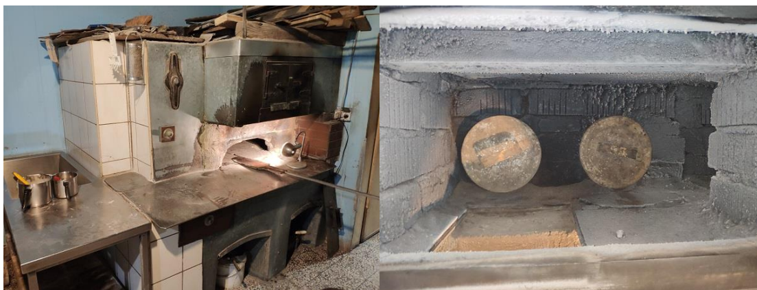
Rysunek 4.39 Widok akumulacyjnego tradycyjnego pieca chlebowego oraz elementy zaślepiające komin na czas wypieku. Źródło: opracowanie własne
