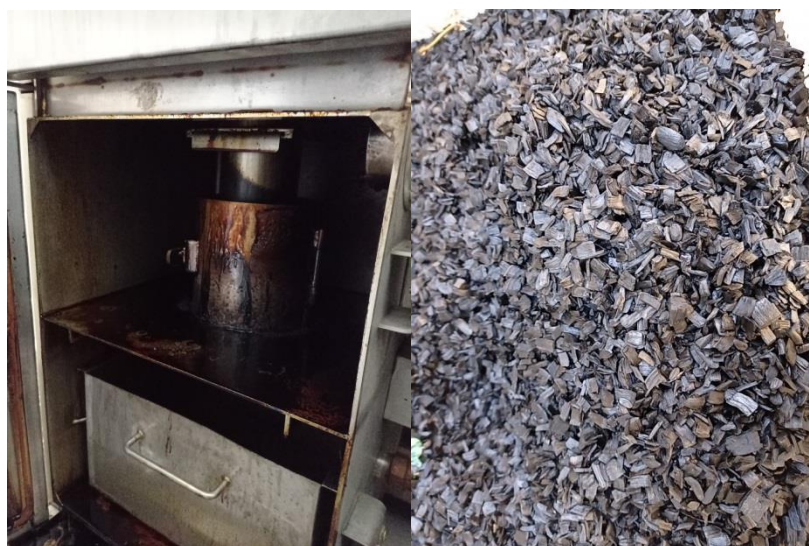
Rysunek 4.63 We wnętrzu wytwornicy dymu wędzarniczego znajduje się naczynie, w którym częściowemu zgazowaniu ulegają zrębki drzewne. Po prawej pozostałość po wiórkach. Źródło: opracowanie własne
