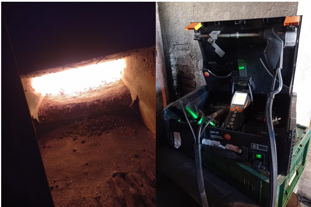
Rysunek 4.29 Widok paleniska oraz użyty w trakcie badań pyłomierz TESTO 380. Źródło: opracowanie własne
