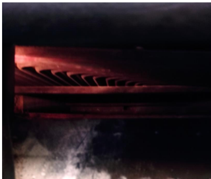
Rysunek 4.33 Wnętrze komory wypiekowej pieca RRK, widoczne rurki Perkinsa w górnej części. Źródło: opracowanie własne
