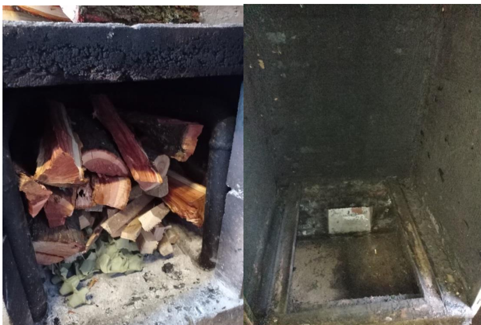
Rysunek 4.68 Komora paleniskowa wypełniona paliwem przed rozpalaniem, po prawej komora wędzarnicza tradycyjna oraz widok pustego paleniska. Źródło: opracowanie własne
