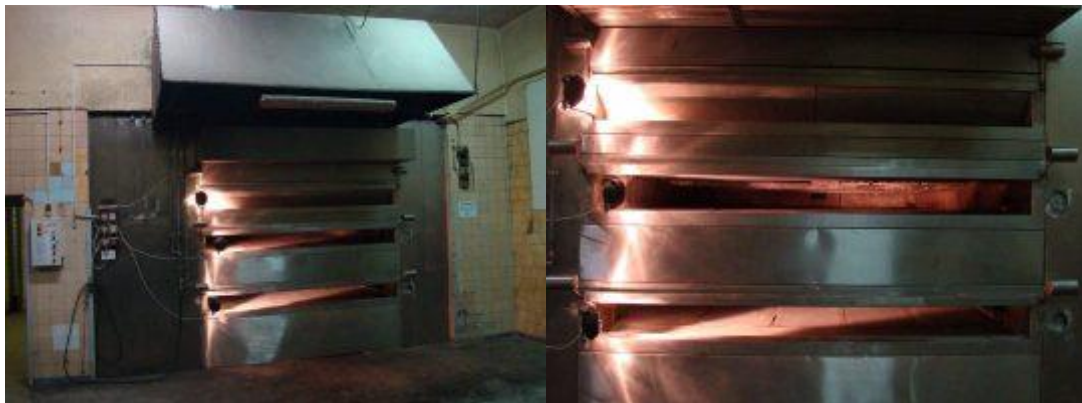
Rysunek 5.13 Widok na poszerzone drzwi pieca RRK. Źródło: www.piecemakuch.pl/piece-piekarnicze
