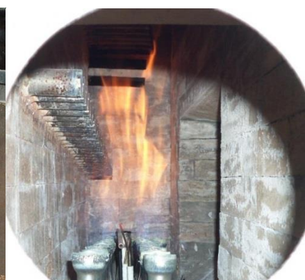
Rysunek 5.16 Zastosowanie palników gazowych w piecach piekarniczych (widoczne rozwiązania włoskie). Źródło: www.bakeres.pl
