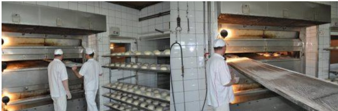
Rysunek 5.12 Proces załadunku pieca RRK. Źródło: www.piecemakuch.pl/piece-piekarnicze
