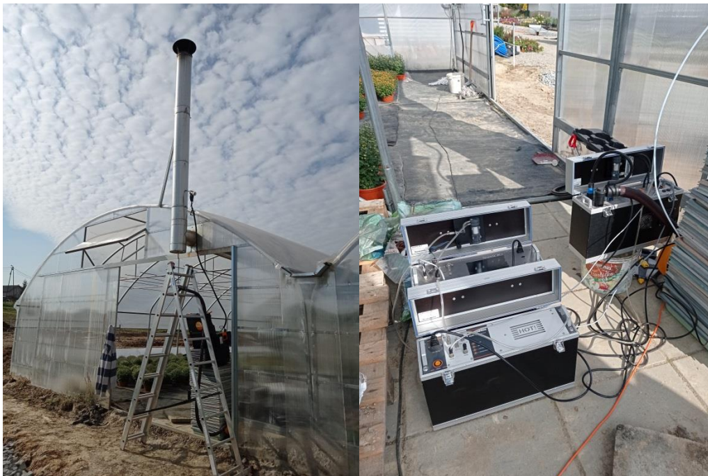
Rysunek 4.25 Aparatura pomiarowa oraz emitor odprowadzający gazy odlotowe ze źródła. Źródło: opracowanie własne
