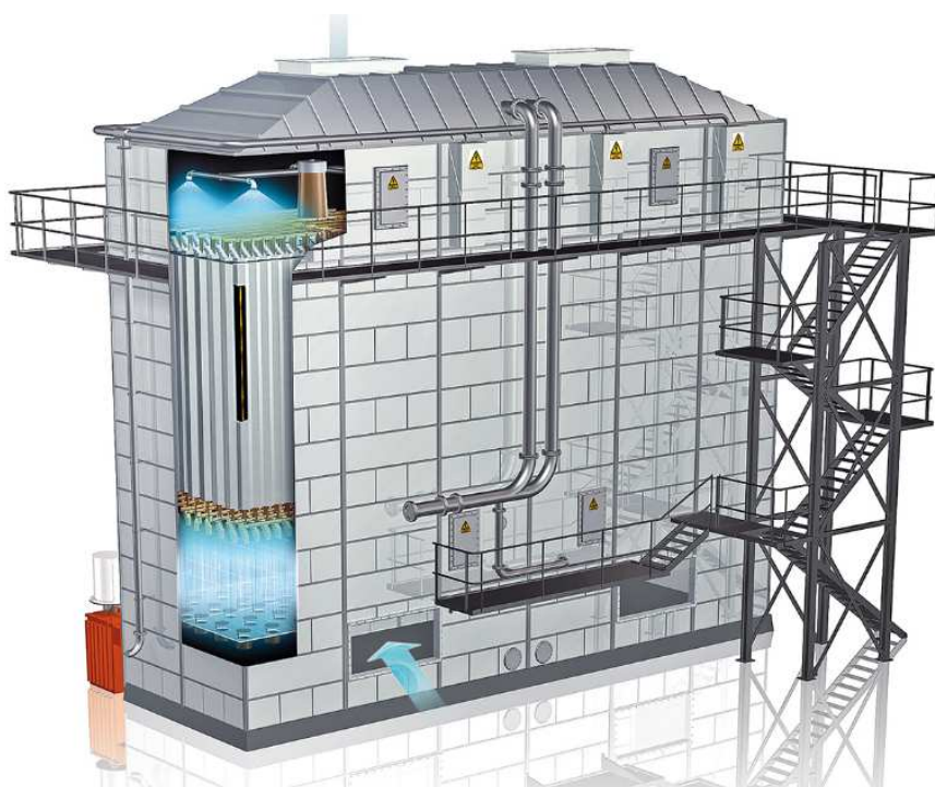
Rysunek 5.1.5.2.2. Widok i przekrój elektrofiltru zwilżanego [15]
