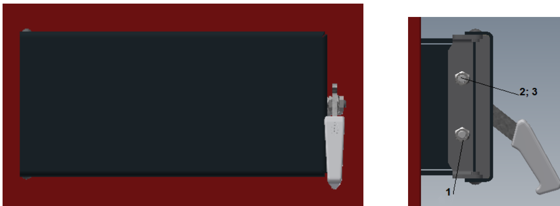
Rys. 13 Mocowanie drzwiczek do ramki kotła (lewe)
