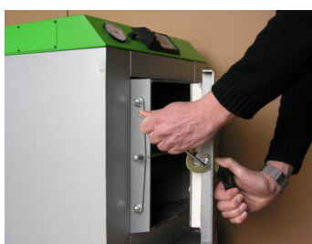
Fot.5. Odkręcić śrubę uchwytu zaciskowego.
