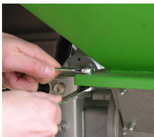
Fot.1. Odkręcić 4 śruby mocujące zbiornik paliwa.
