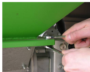
Fot.3. Dokręcić śruby mocujące zbiornik.
