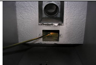
Fot.3. Zdjąć pokrywę wyczystki i opróżnić komorę powietrzną z popiołu.
