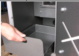
Fot.1. Usuwanie popiołu za pomocą szuflady popielnika.
