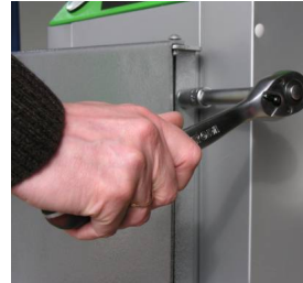
Fot.9. Regulacja drzwiczek (poluzować śruby, ustawić drzwiczki, dokręcić śruby).
