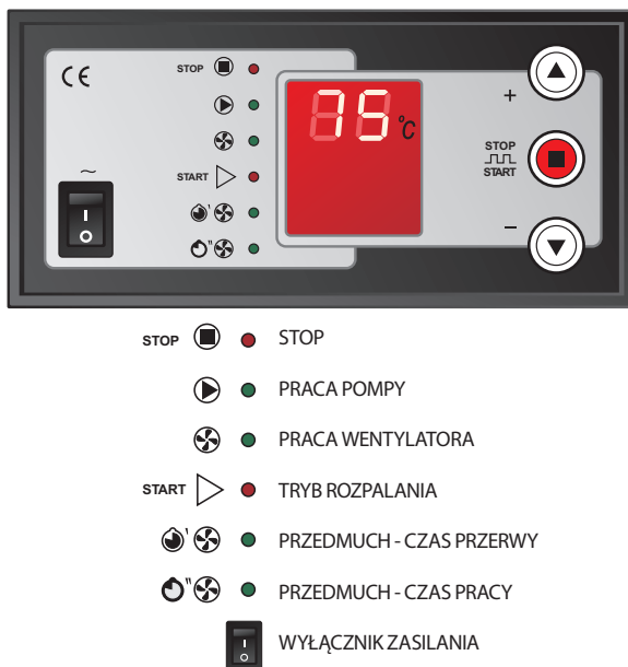
Rys.1 Opis kontrolerek na panelu regulatora.
