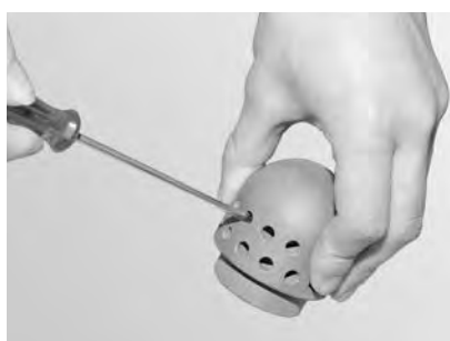
rys.45 Wyczyść otwory powietrza pierwotnego
