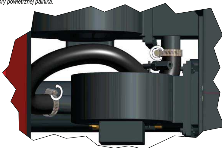
Rysunek 19. Czyszczenie komory powietrznej palnika.
