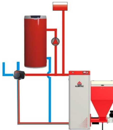
Rys. 9. Układ ogrzewania w trybie LATO – tylko c.w.u.
