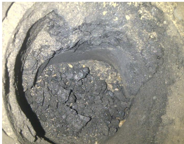
Rys. 10. Nagar powstały podczas spalania – widok retorty z góry.
