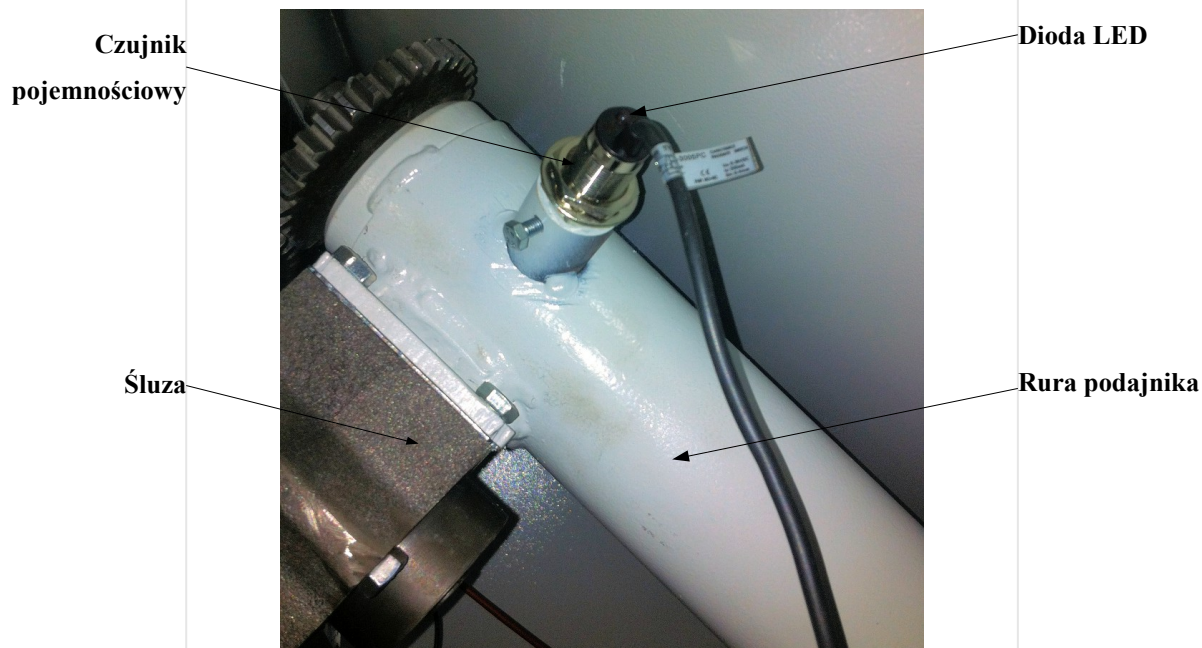
Rys nr 13. Umieszczenie pojemnościowego czujnika zbliżeniowego
