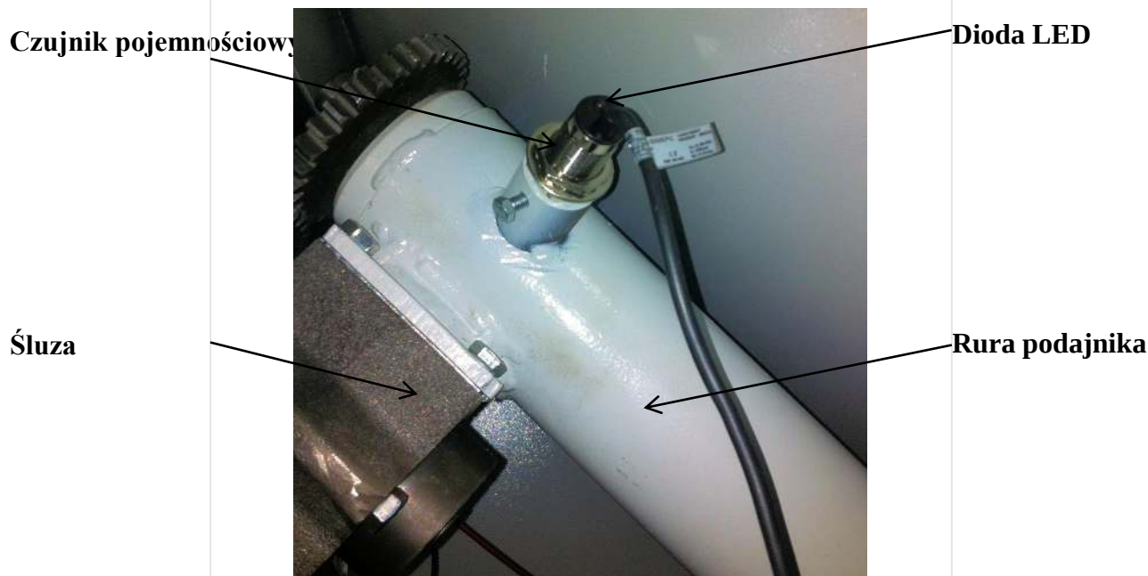
Rys nr 1. Umieszczenie pojemnościowego czujnika zbliżeniowego
