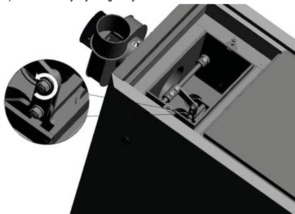
b) Demontaż ramienia mechanizmu czyszczącego
