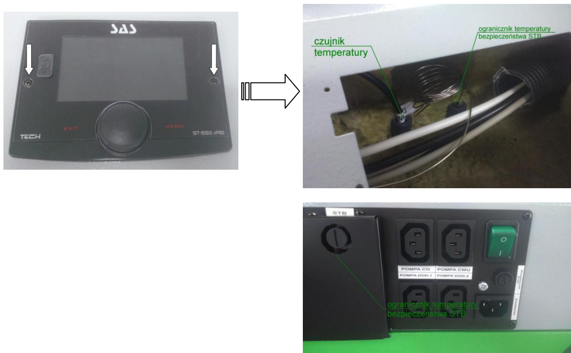
Rysunek 12 Lokalizacja ogranicznika temperatury bezpieczeństwa STB oraz czujnika temperatury
