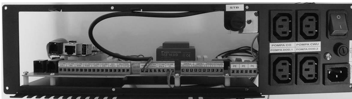
Rysunek 2 Listwa przyłączeniowa do zasilania urządzeń regulacyjnych. (uwaga fot. przedstawia przykładowe rozmieszczenie podłączeń, szczegóły w dołączonej DTR sterownika).
