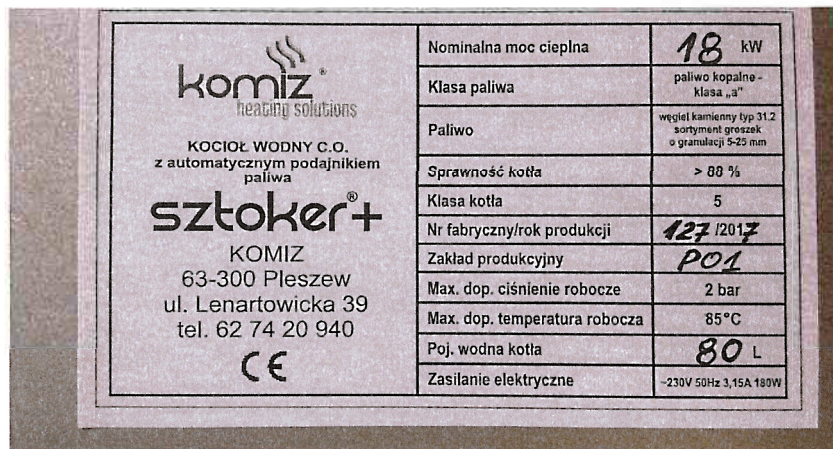
Rysunek 3. Tabliczka znamionowa kotła SZTOKER+ 18
