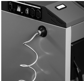
Rysunek 5 Miejsce montażu czujnika temperatury z kapilarą – zawór zabezpieczenia termicznego
