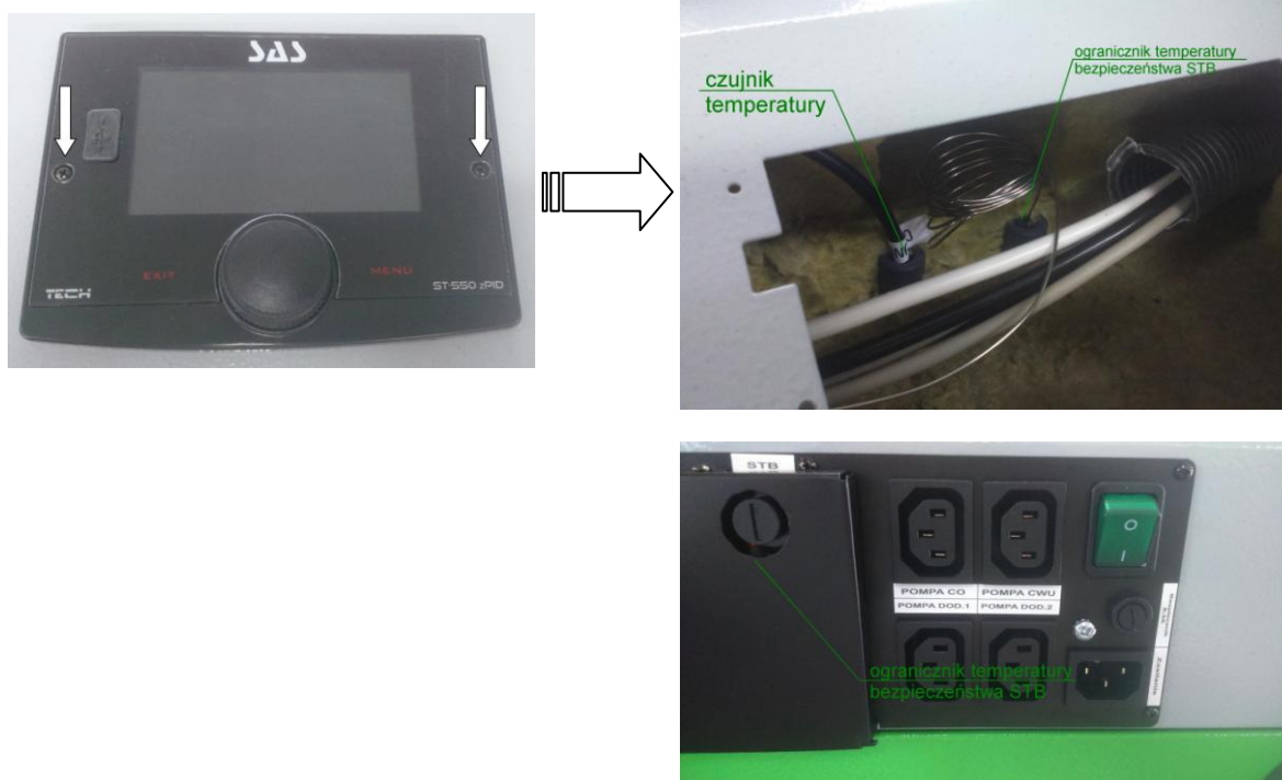
Rysunek 8 Lokalizacja ogranicznika temperatury bezpieczeństwa STB oraz czujnika temperatury
