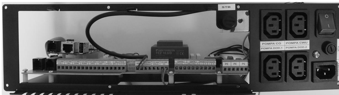
Rysunek 1 Listwa przyłączeniowa do zasilania urządzeń regulacyjnych (uwaga fot. przedstawia przykładowe rozmieszczenie połączeń, szczegóły w dołączonej DTR sterownika).
