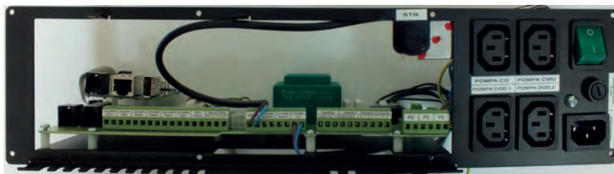
Rysunek 1 Listwa przyłączeniowa do zasilania urządzeń regulacyjnych
