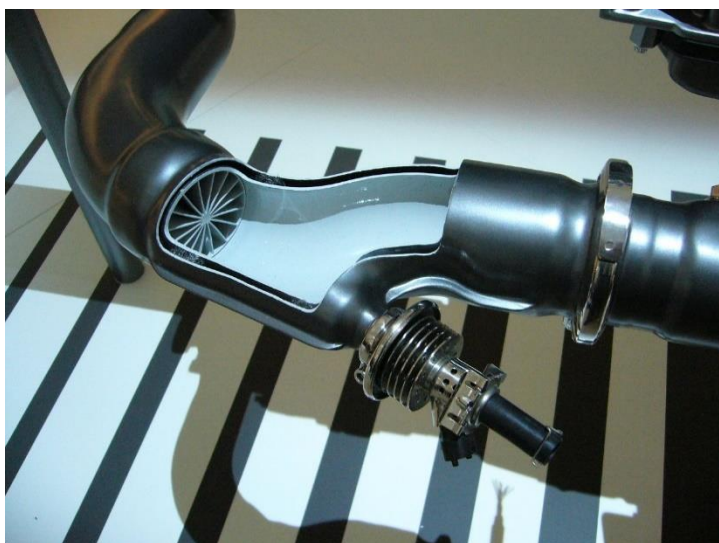
Rysunek 19. Komora wtrysku i mieszania AdBlue w systemie selektywnej redukcji katalitycznej.
