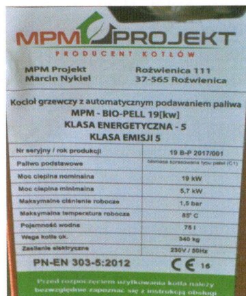
Rys. 2. Tabliczka znamionowa kotła typu MPM Bio-Pell 19 (MPM Pellets Boiler 19).
