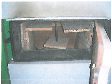
Ceramiczny deflektor i obrotowy palnik retortowy w komorze spalania
