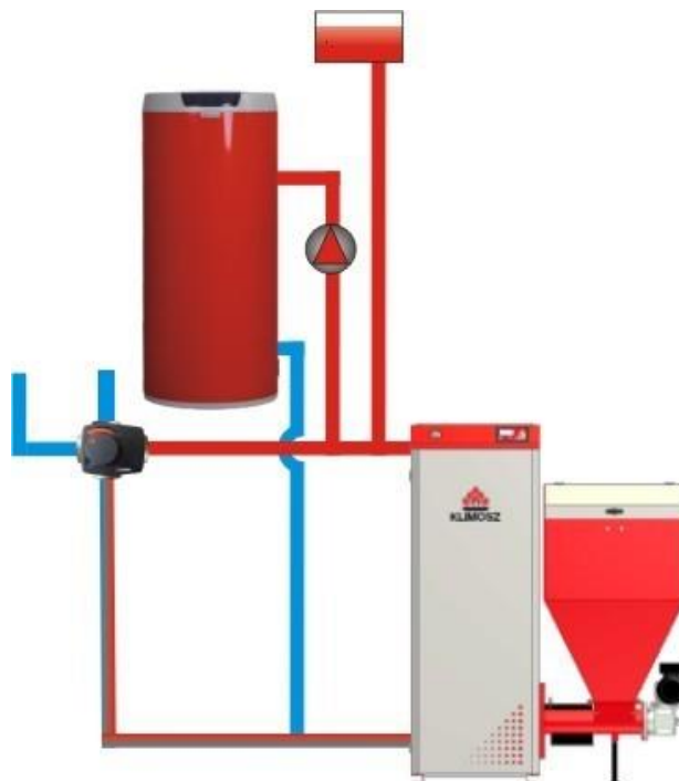
Rys. 12. Układ ogrzewania w trybie LATO – tylko c.w.u.
