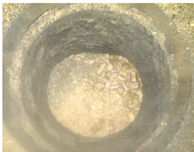
Rys. 14. Nagar powstały podczas spalania pe- Rys. 15. Palnik retortowy oczyszczony z nagaru – let – widok kolana retorty z góry. widok kolana retorty z góry.
