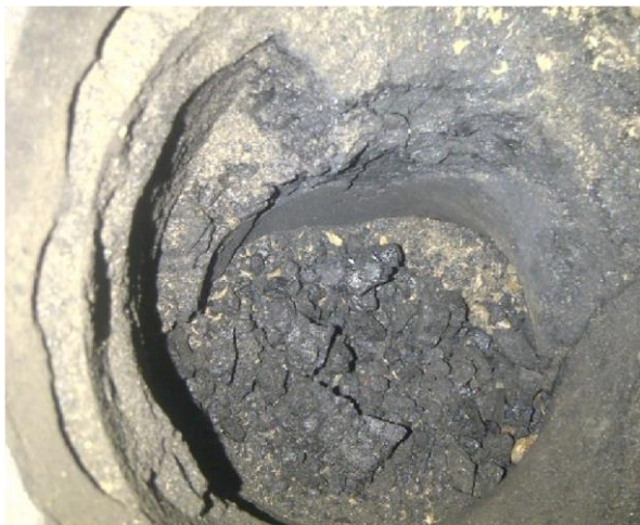
Rys. 14. Nagar powstały podczas spalania pe- Rys. 15. Palnik retortowy oczyszczony z nagaru – let – widok kolana retorty z góry. widok kolana retorty z góry.
