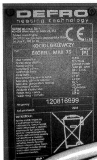
Rys. 2. Tabliczka znamionowa kotła typu Ekopell Max 75.
