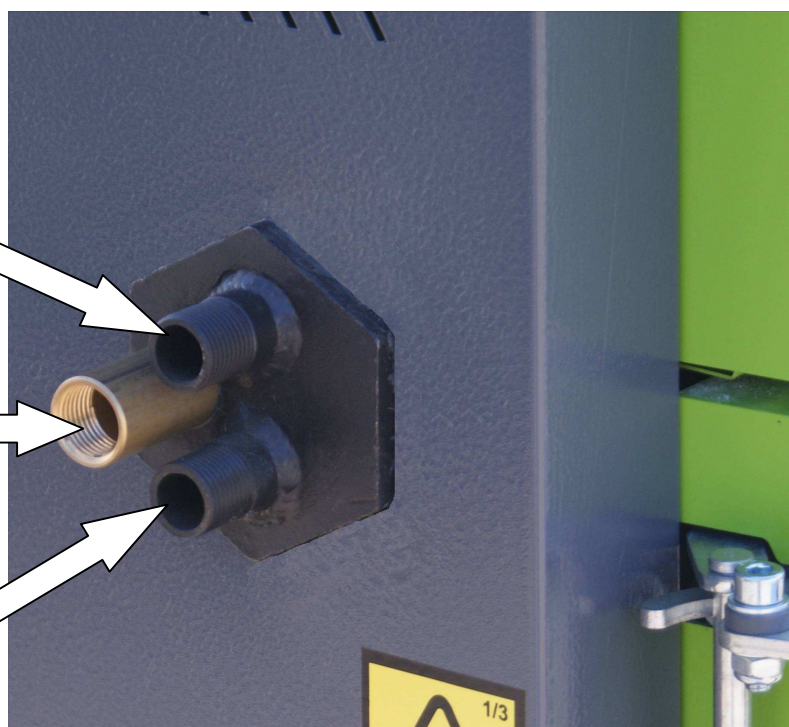
Rys. 2.6.3. Zamontowana wężownica schładzająca, instrukcja podłączenia zaworu termostatycznego JBV1.
