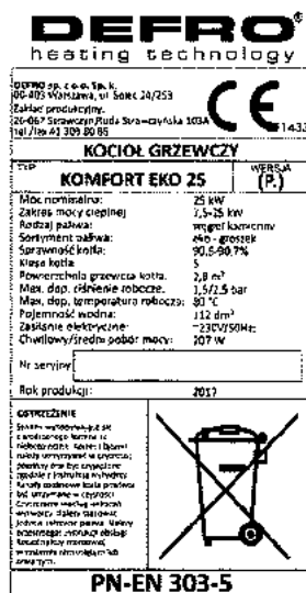
Rys. 2. Tabliczka znamionowa kotła typu KOMFORT EKO 25 (KOMFORT EKO LUX 25).
