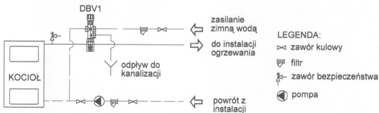
Rys.6 Schemat instalacji z dwudrogowym zaworem bezpieczeństwa DBV1.
