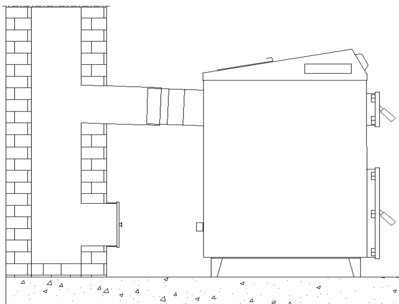
Rys. 3 Podłączenie kotła do komina
