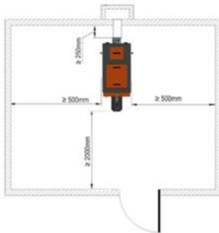
Rys. 3 Ustawienie kotła w pomieszczeniu kotłowni
