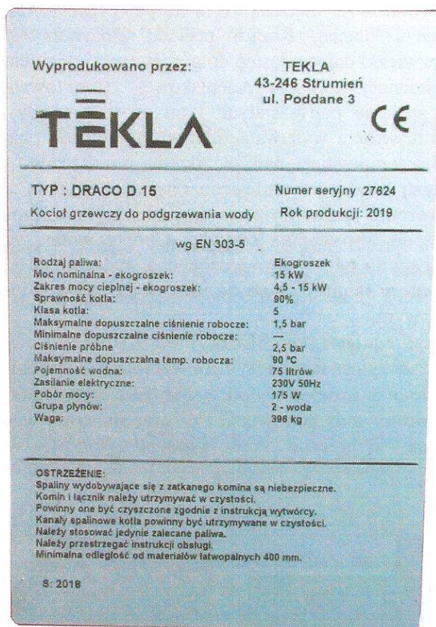
Rysunek 2. Tabliczka znamionowa kotła Draco D 15
