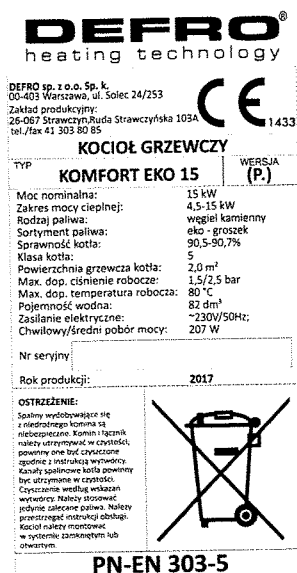
Rys. 2. Tabliczka znamionowa kotła typu KOMFORT EKO 15 (KOMFORT EKO LUX 15).
