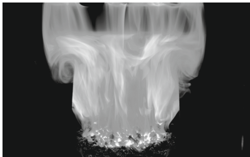
Rysunek 14. Prawidłowy obraz ognia w palenisku.
