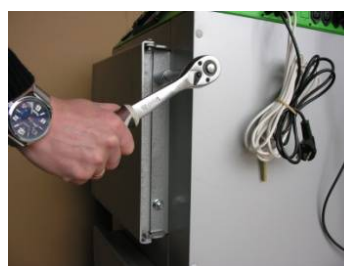
Fot.6. Zdemontować drzwiczki z węża.
