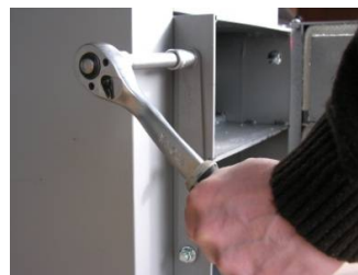
Fot.3. Odkręcić rygiel zamka
