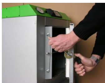
Fot.4. Odkręcić śrubę uchwytu zaciskowego.
