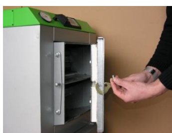
Fot.5. Wyjąć podzespoły mocowania uchwytu.
