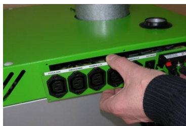
Fot.1. Odkręcić przyłączy zasilające czujnikowe
