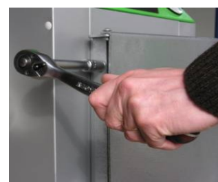
Fot.8. Przykręcić śruby montażowe zawiasów
