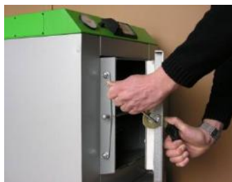
Fot.4. Odkręcić śrubę uchwytu zaciskowego.
