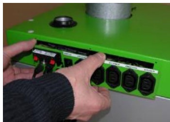
Fot.2. Przykręcić po drugiej stronie obudowy górnej
