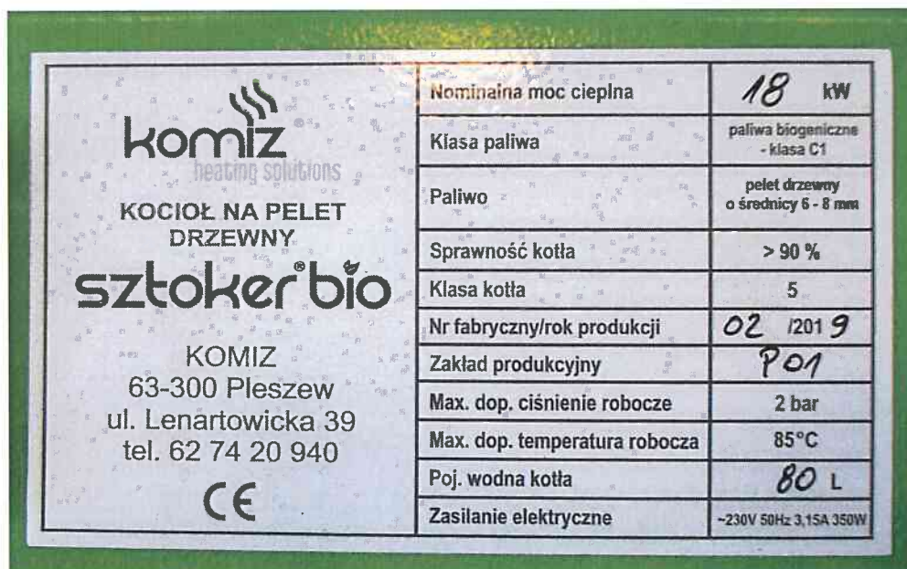
Rysunek 3. Tabliczka znamionowa kotła
