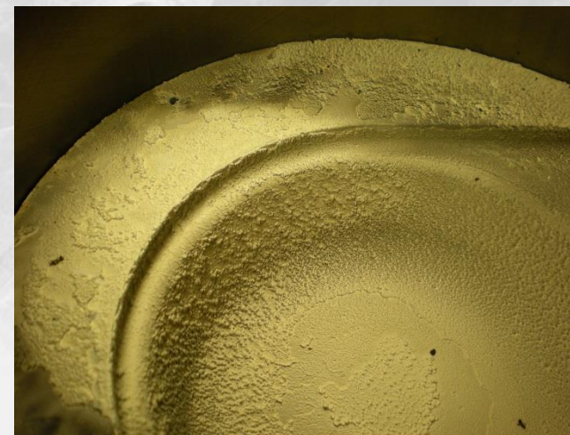
Tłok silnika (osad z siarki)
