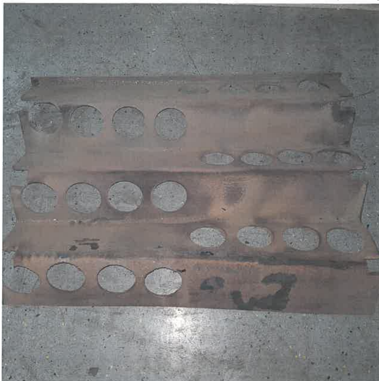
Rysunek 8 Rodzaj zamontowanego zawirowywacza w dolnej części wymiennika
