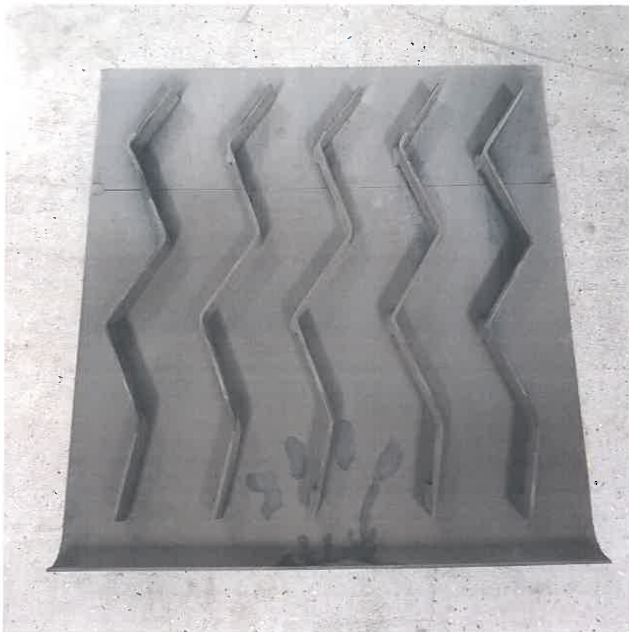
Rysunek 7 Rodzaj zamontowanego zawirowywacza w górnej części wymiennika
