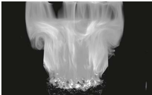
Rysunek 14. Prawidłowy obraz ognia w palenisku.
