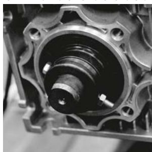
Krok 7. Prawidłowo założona śruba
