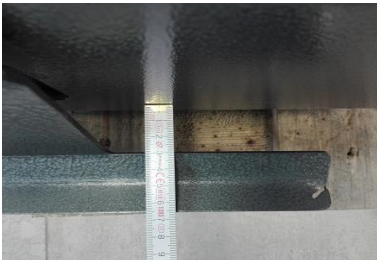
Rys. nr 10. Nastawy klapki powietrza pierwotnego przy mocy nominalnej- paliwo drewno
