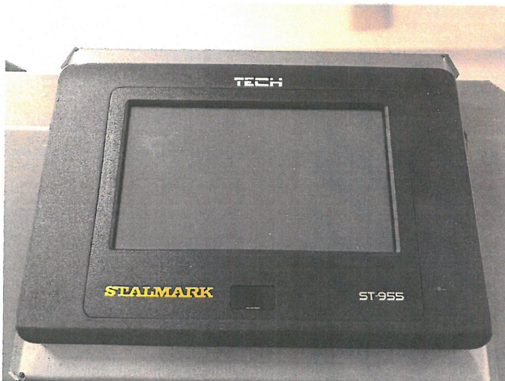
Rysunek 12 Układ kontrolno – sterujący ST-955 firmy Tech
