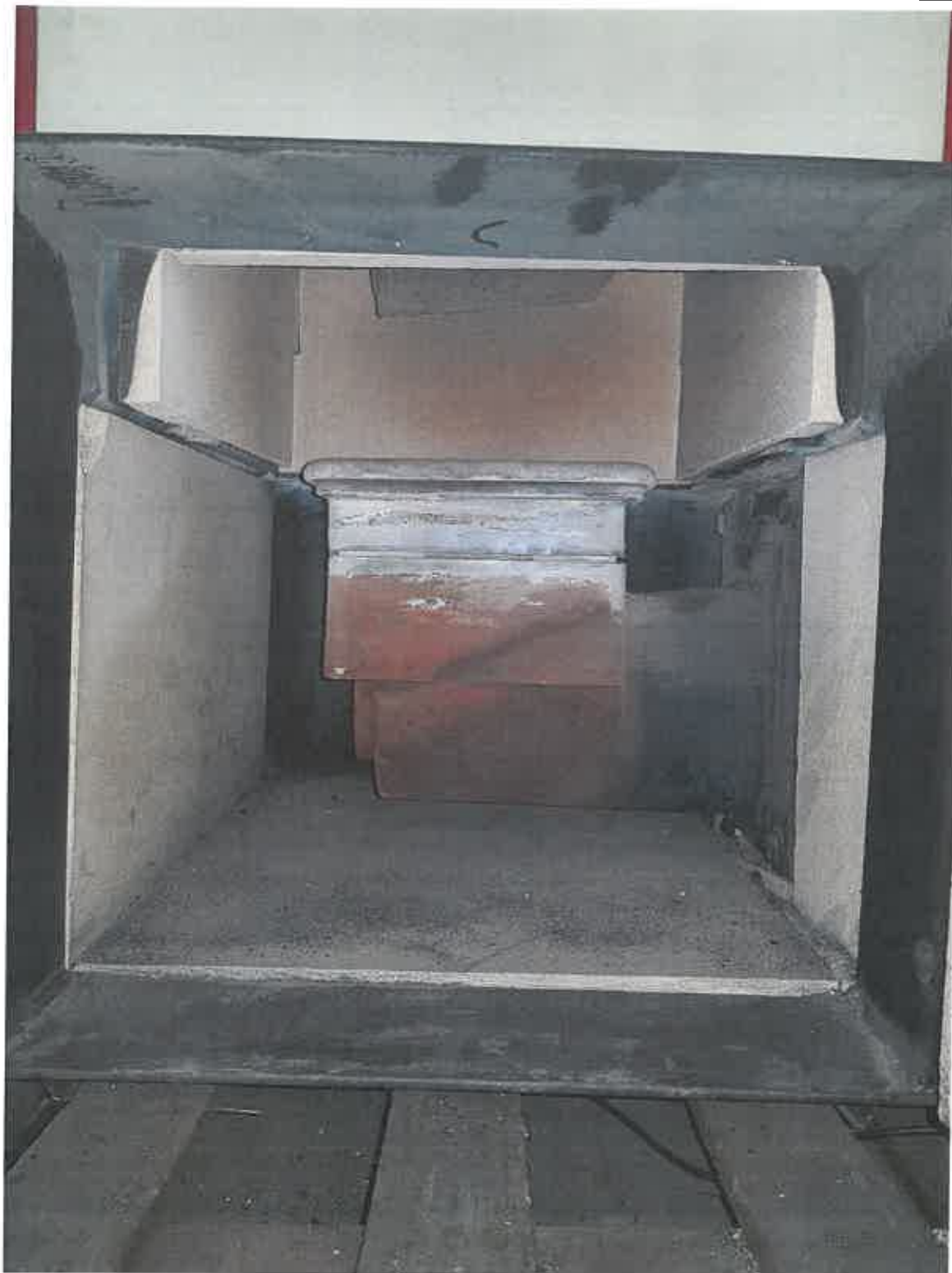
Rysunek 6 Popielnik, elementy ceramiczne komory spalania oraz palnik retortowy 15–25 kW produkcji P.H.U.P. Ekoenergia S.C.
