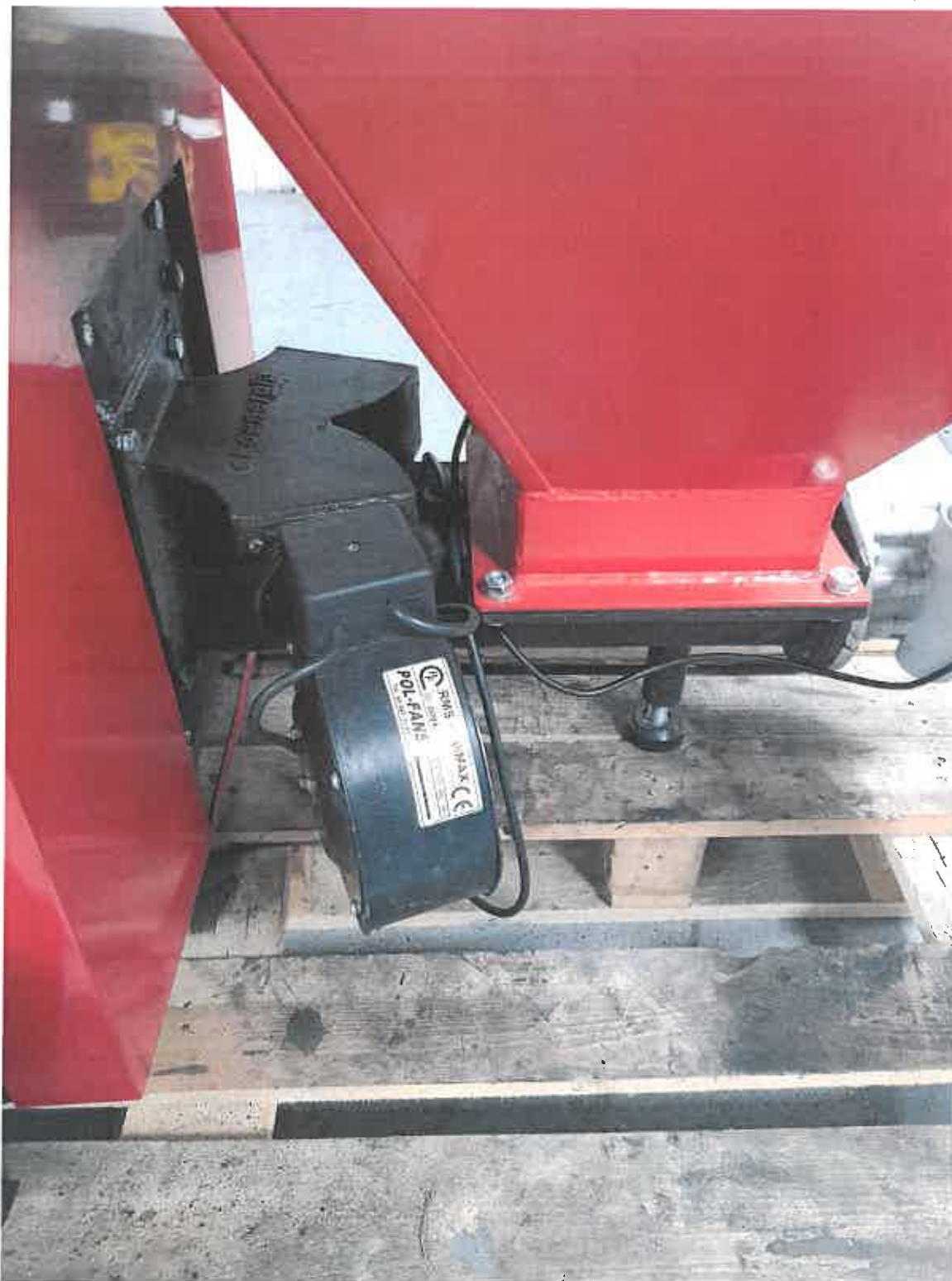
Rysunek 6 Palnik retortowy 20 kW produkcji P.H.U.P. Ekoenergia S.C. oraz dmuchawa RMS-140/MAX firmy POL-FANS
