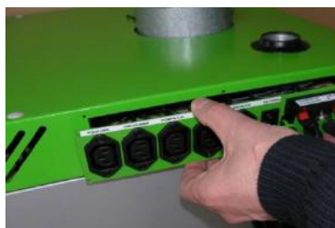
Fot.1. Odkręcić przyłączy zasilająco-czujnikowe
