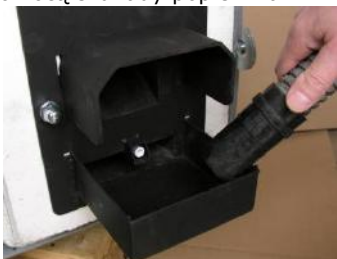
Fot.4. Czyszczenie komory powietrznej palnika QPel
