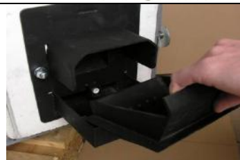
Fot.3. Czyszczenie tygla palnika QPel
