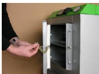
Fot.10. Po odwróceniu zamontować uchwyt zaciskowy.
