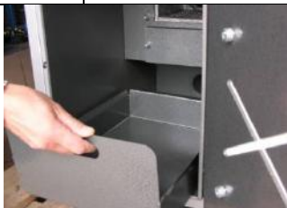
Fot.1. Usuwanie popiołu za pomocą szuflady popielnika.
