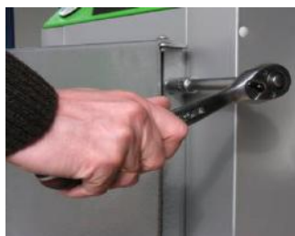
Fot.7. Regulacja drzwiczek (poluzować śruby, ustawić drzwiczki, dokręcić śruby).
