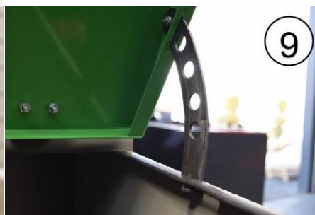
Zdj. 9. Pokrywa zasobnika z mechanizmem blokującym
