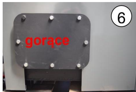
Zdj. 6. Płyta ochronna
