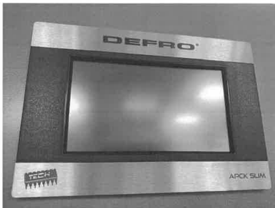
Rysunek 9 Panel kontrolny układu kontrolno - sterującego firmy Tech Sterowniki Sp. z o.o. Sp. K.
