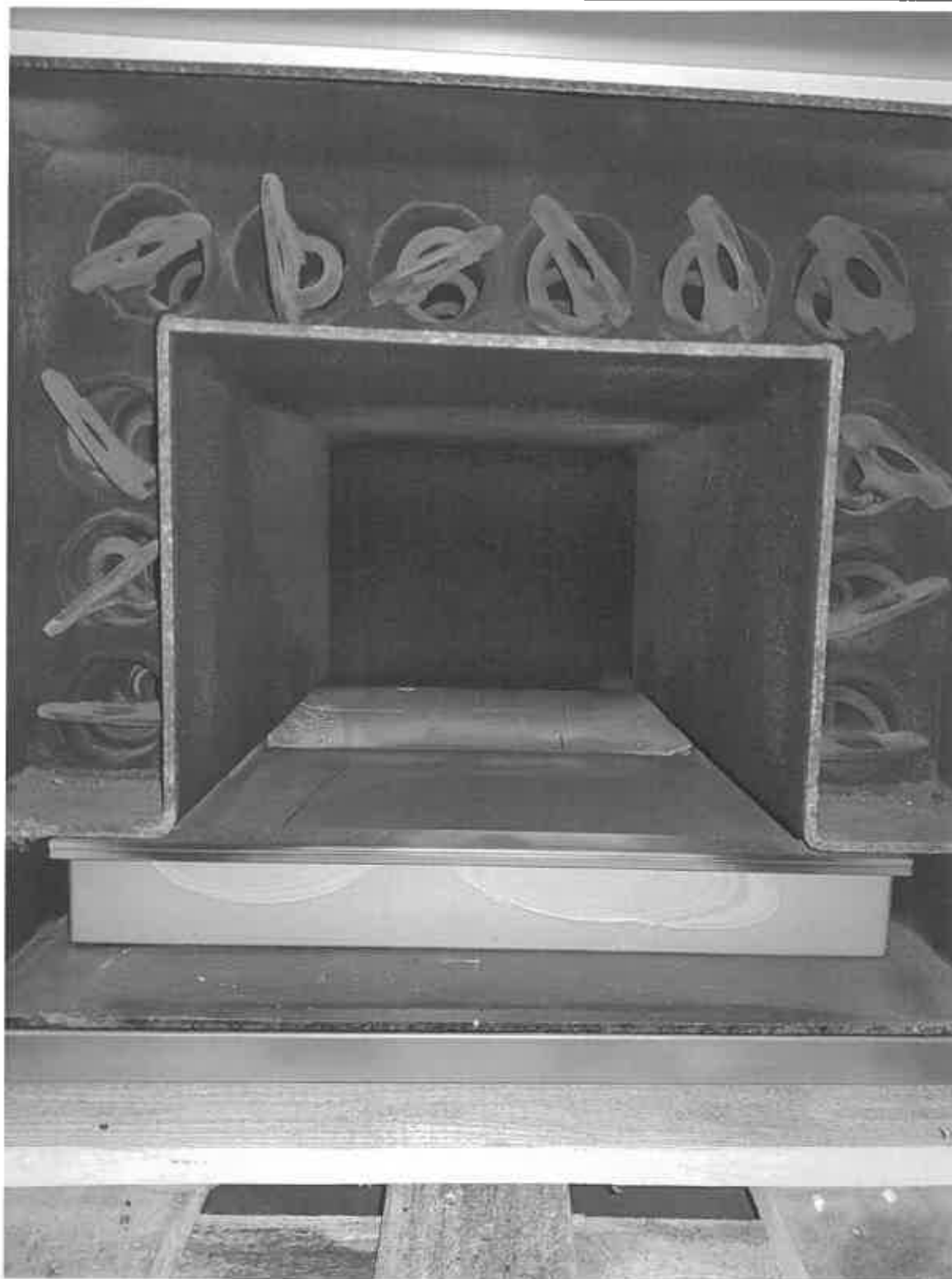
Rysunek 6 Komora spalania, komora popielnikowa oraz rury płomieniowe z zainstalowanymi zawirowywaczami
