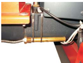
Rys. 5. Czujnik temperatury zamocowany za pomocą opasek zaciskowych
